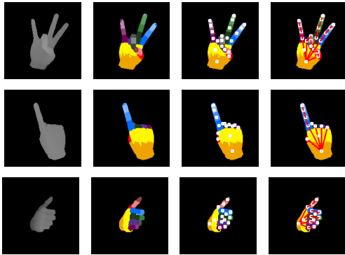
Şekil 3: Sentetik AİD örnekleri ve oturtulan iskeletler: En solda derinlik imgeleri, sonra sırasıyla etiket imgeleri, eklem pozisyonları ve bulunan 3B iskeletler görülmektedir.
