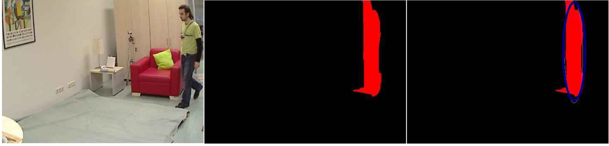
Şekil 2. Çerçevden arka plan ayrıştırma ve silüet üzerine elips modeli oturtma.
